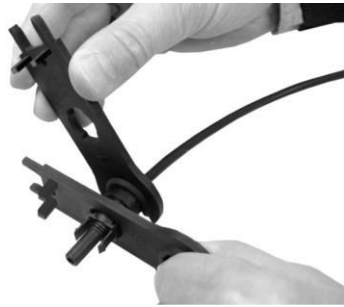
Figura 29 - Aperto do prensa cabo
