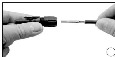
Figura 28 - Introdução do terminal no prensa cabo
