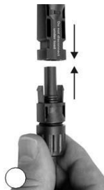
Figura 30 - Conectando MC4 da série fotovoltaico na sua respectiva entrada do inversor
